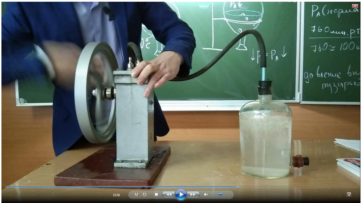
Рис.17 Понижение давление с помощью насоса «Комовского»
